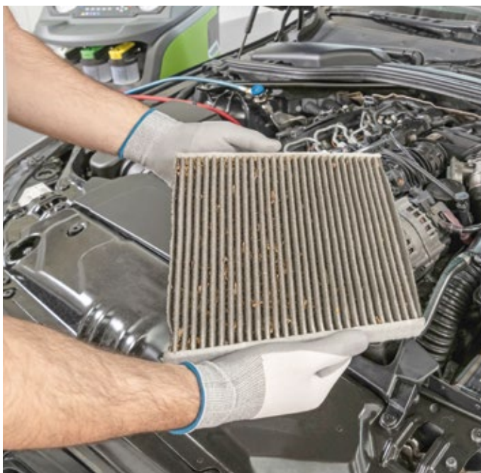
Selbst der Laie erkennt auf einen Blick: Dieser Filter hat seinen Zweck erfüllt und sollte ausgetauscht werden.
